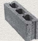
Size: 49×14.5×20 Max.Weight: 9.5 Kg Sound Resistance: 46 db دیواری تو خالی ته پر با سه سوراخ
