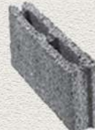
Size: 40×7×20 Max.Weight: 3.7 Kg Sound Resistance: 46 db تیغه ای تو خالی ته پر با دو سوراخ
