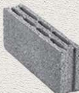
Size: 49×10×20 Max.Weight: 7.5 Kg Sound Resistance: 47db تیغه ای تو خالی ته پر (سه جداره)
